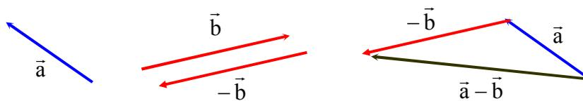
Fig. 1.4 - Subtração geométrica dos vetores  $\vec{a}$  e  $\vec{b}$ .
